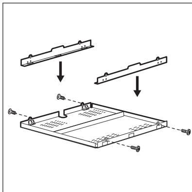
Si utiliza una caja de protección (accesorio adicional) no son necesarios el espacio de ventilación frontal de 2 mm y el suelo protector directamente por debajo del aparato. El accesorio de la caja de protección puede no estar disponible en algunos países. Póngase en contacto con el proveedor local.
