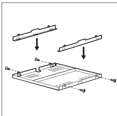
Se utilizar uma caixa de protecção (acessório adicional), o espaço de ventilação frontal de 2 mm e o piso protector, directamente por baixo da placa, não são necessários. A caixa de protecção acessória pode não estar disponível em alguns países. Contacte o seu fornecedor local.
