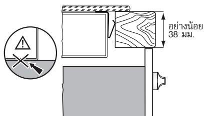
**คำเตือน!** หากอุณหภูมิที่ผิวน้ำชาสูงเกิน 95 °C ห้ามเข้าไปใต้เครื่อง เพื่อป้องกันอันตรายที่อาจเกิดขึ้นและต้องติดตั้งพนังทบทวนความร้อน
