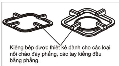
8. Giá đỡ nhỏ chỉ được thiết kế dạng phẳng để hỗ trợ khi sử dụng nồi có kích thước tối thiểu 100mm.
