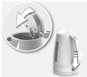
4. ปิดฝา ตรวจสอบให้แน่ใจว่า ล็อคฝาที่ได้ถูกตั้งไว้ในชั้นนั้นระบบ ปิดการทำงานอัตโนมัติอาจไม่ทำงาน วางแผนร้อนน้ำ กดปุ่ม ON/OFF จากนั้นไฟแสดงการทำงานจะติดสว่าง และจะเริ่มทำความร้อน
